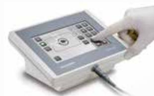
Pratique et conviviale : la télécommande marTouch® contrôle les éclairages opératoires et le système de caméra surgiCam® et permet à l'utilisateur d'obtenir de nombreuses autres informations. Y compris station d'accueil, avec fixation sur table ou murale.
